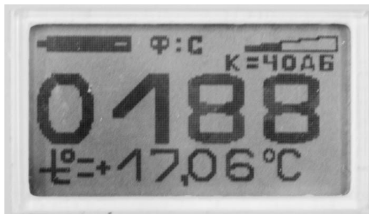
Рис.12. Режим измерения уровня вибрации и температуры грунта
