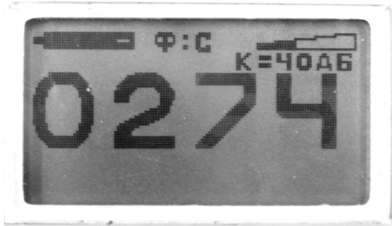
Рис.9. Режим измерения уровня вибрации грунта
