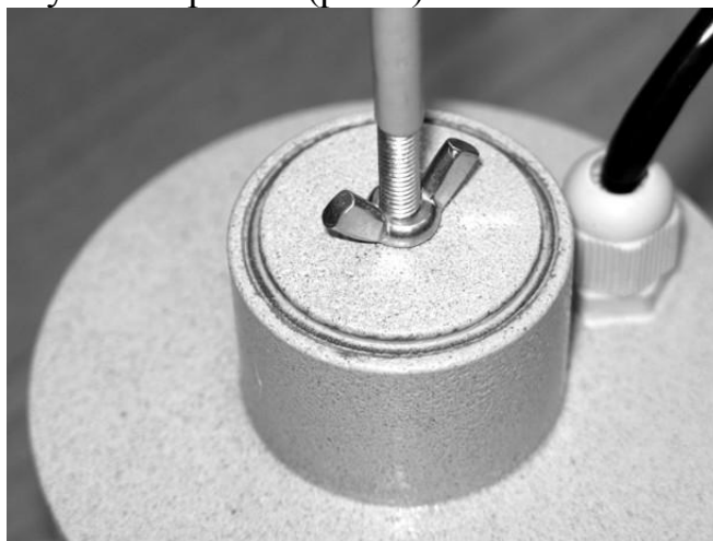
Рис.3. Фиксация рукоятки ВТДГ-2 с помощью барашка.
