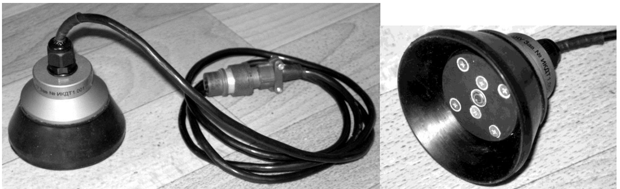
Рис. 4. Бесконтактный датчик теплового излучения ИКДТ-2. а) Общий вид. б) Вид со стороны чувствительного элемента.
