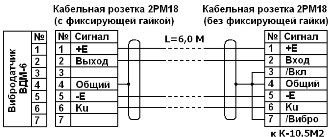
Рис.10. Схема подключения вибродатчика ВДГ-6 к входному разъему ВРБ течеискателя К-10.5м2
