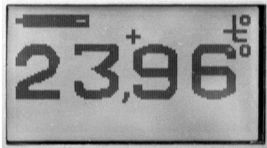
Мал.10. Приклад екрану в режимі вимірювання температури ґрунту
